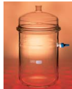
Appareil à filtration de Witt, complet avec couvercle inter- changeable, KECK™ set de montage 1
