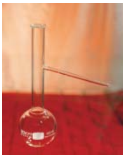
Engler-Kolben Flasks, distilling, Engler
