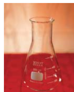
Fioles Erlenmeyer à col large avec graduation, DIN 12 385
