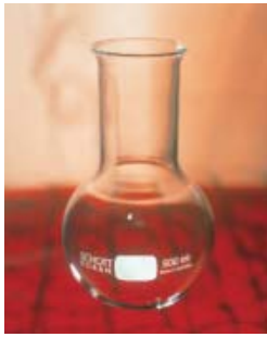
Stehkolben weithalsig, mit Bördelrand DIN 12 347
