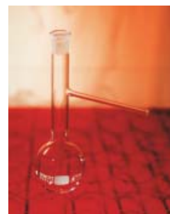
Ballons à distiller d'Engler avec tubulure RIN 19/26, DIN 51751
