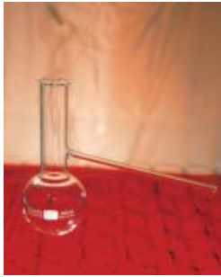
Destillierkolben Flasks, distilling
